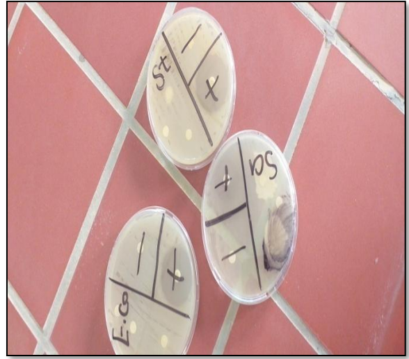
صورة رقم (3) توضح نتيجة اختبار اقراص اوراق الترشيح.
